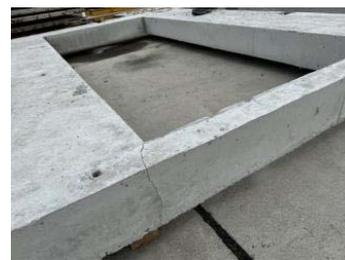
图1 装配式农房裂缝图
