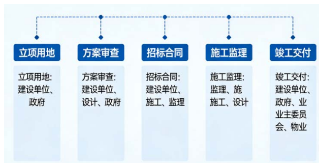
图1 住宅建筑工程管理的适用范围
