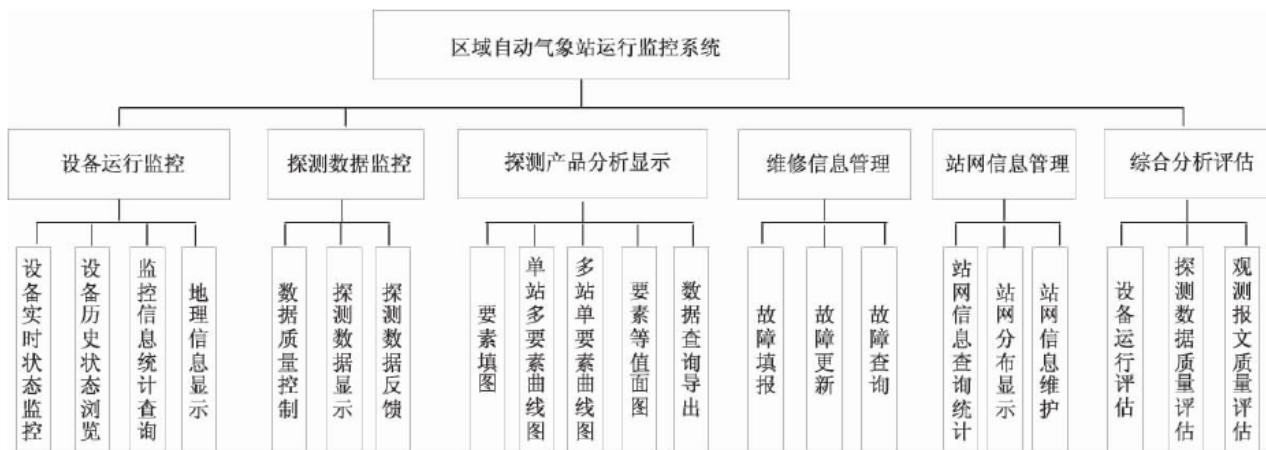
结语中国区域自动气象站运行监控系统是针对我国已建区域自动气象站以及未来将建的加密自动站和暴雨监测站而建设的监控保障实时业务系统。系统分国家级和省级两个版本，分别在国家级和省级保障部门安装部署。两级系统采用相同技术架构，基本功能均包括设备运行监控、探测数据监控、探测产品分析显示、维护维修管理、站网信息管理和综合分析评估 6 部分。系统的建成将在一定程度上保障我国区域自动气象观测网的稳定、可靠运行。然而，为更好地发挥其效益，系统还需在探测数据质量控制方法、相关业务机制和职责流程方面进一步完善。
