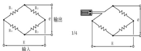
图1 1/4桥连接方式
